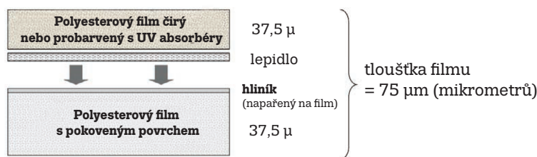
Obr. 1: Skladba dvovrstvého stínění MULTIFILM®
